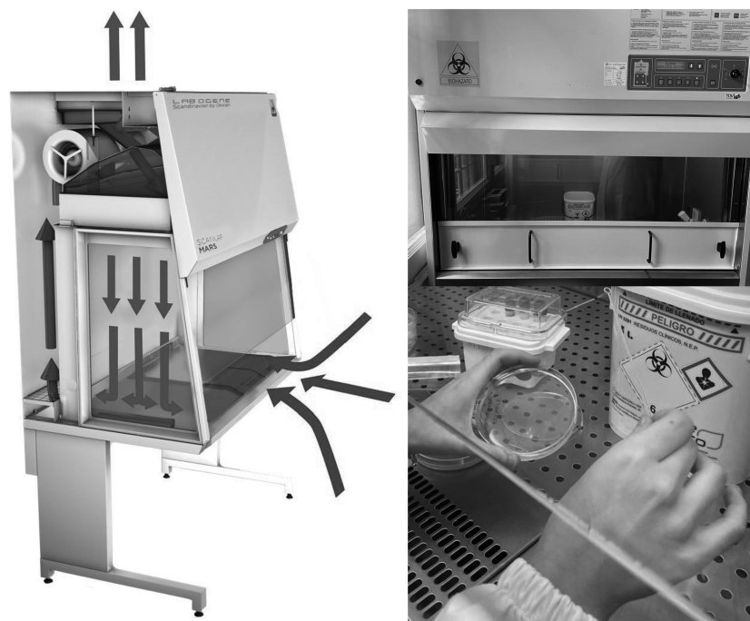
Figura 2.1. Cabines de seguretat biològica de classe II. Confereixen protecció a la mostra davant la contaminació externa i també inclouen un flux d'aire vertical que protegeix l'operari enfront del microorganisme.
