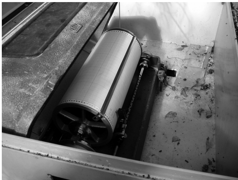
Figura 6. Imatge del limnígraf i del limnigrama.
