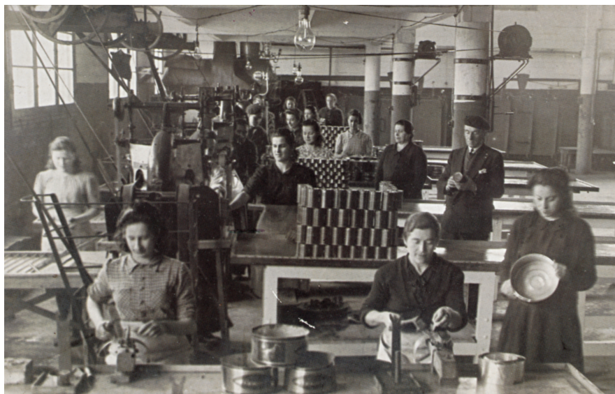
□ Fotografía II.6. Moldeando los cuerpos de las latas.
